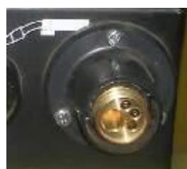
4. Centralni priključak (MMT200A – EN – 0009)
