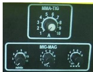
7. Potenciometri za podešavanje radnih parametara (MMT200A – EL – 0004)
