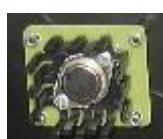
15. Stabilizator napona (MMT200A – EL – 0018)
